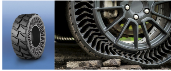
Figure 1: Pneumatiques sans air ou roues porteuses conçues par la MFP MICHELIN : le TWEEL (2012) à gauche et le prototype UPTIS (2019) à droite.
