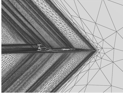
Figure 2: Maillage adapté fortement anisotrope pour un calcul dont la solution présente des chocs: l'estimation d'erreur et la prescription de tailles qui en découle est automatique et ne dépend que de la solution approchée.
