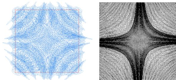
Figure 1: Champ de métriques  $\mathcal{M}$  (à gauche) et maillage unité (à droite) dans  $\mathcal{M}$ : malgré leur étirement dans l'espace Euclidien, les éléments ont bien des arêtes de longueur 1 dans  $\mathcal{M}$ .
