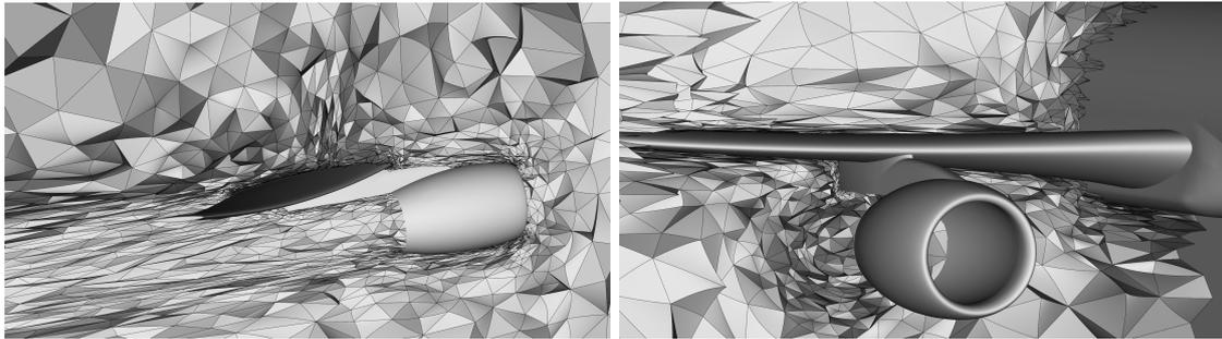
Figure 3: Maillages courbes issus d'une simulation en mécanique des fluides sur une géométrie complexe.
