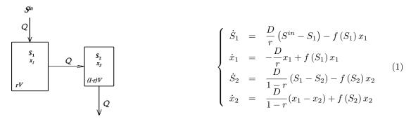
Nous analysons le système (1) qui se compose de quatre équations différentielles modélisant le dispositif en série. Deux équations pour chaque réservoir définies selon la concentration de substrat en entrée  $S^{in}$ , la concentration de substrat  $S_i$  et la biomasse  $x_i$  i=1,2 se trouvant à l'intérieur de chaque réservoir et par le taux de dilution global du procédé D défini par D=Q/V, ([1], [3]). Dans ce modèle, nous prenons un taux de conversion égal à 1 (sans perte de généralité).
